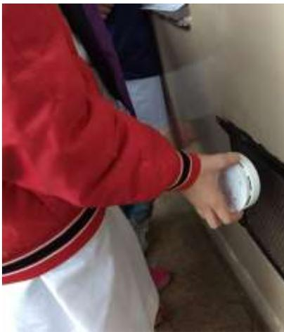
Utilizando el detector de CO en las salidas de las estufas con tiro balanceado.
