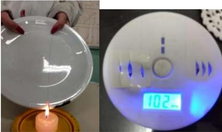
Explorando residuos del CO, a partir de distintos objetos cotidianos como un una vela y un sahumerio encendido cerca y luego de 2 min junto al detector.
